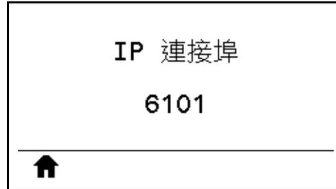
此印表機設定係指 TCP 列印服務接聽的內部有線列印伺服器連接埠號碼。主機的正常 TCP 通訊應直接傳送到此連接埠。
