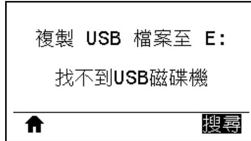
\* 只有在已將 USB 快閃磁碟機插入印表機上可選用的 USB 主機連接埠時，才能使用此功能表項目。
