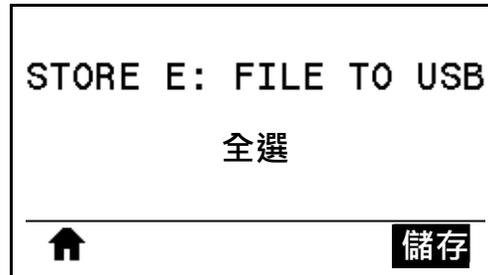
**全選** 選項可用於將印表機上所有可用的檔案儲存到 USB 快閃磁碟機上。將對所複製的任何 .ZPL 檔案進行後處理，讓檔案內容適合傳送到印表機以便正常執行。
